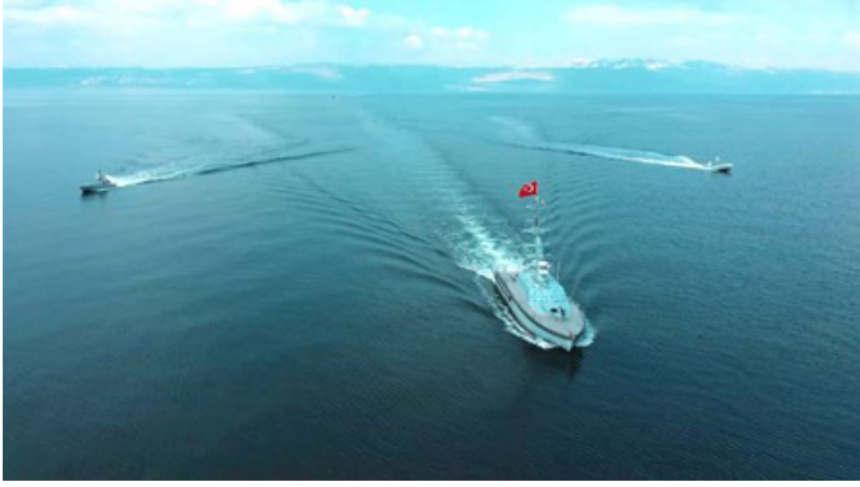
Farklı Deniz Platformların Heterojen Sürü Mimarisinde Formasyonu (MİR İDA ve Albatros-S İDAlar ile Sürü Oluşturma)
