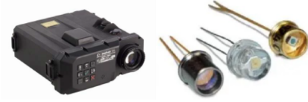
Lazer Mesafe Ölçer (Sol) ve Lazer Mesafe Ölçerlerde Kullanılan APD (Sağ)
